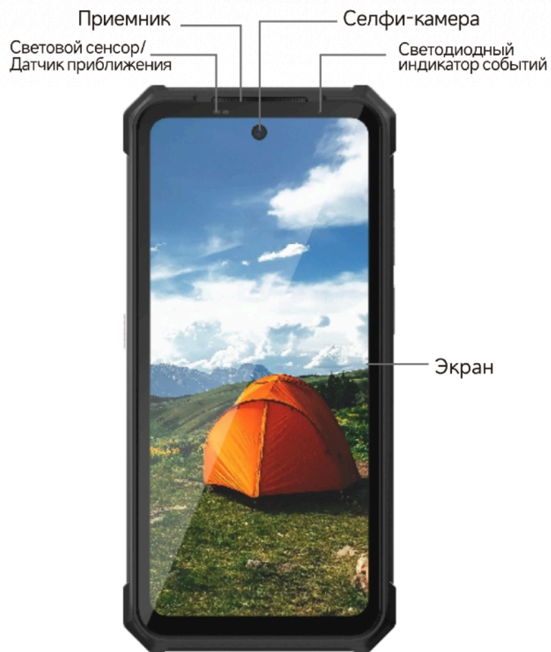
Рисунок 1 — Общий вид устройства (лицевая сторона): экран, фронтальная камера, сенсоры
